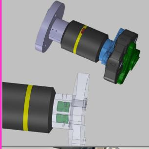
Das J4T-Telemetriesystem ermöglicht die gleichzeitige Übertragung von vier Thermoelement-Signalen von rotierenden Wellen. Die Installation bietet vier Thermoelementbuchsen für eine einfache Zugänglichkeit. Die Sensorverkabelung erfolgt über eine Hohlwelle vom Differentialgetriebe. Eine hocheffiziente induktive Stromversorgung macht es zu einer idealen und zuverlässigen Lösung sowohl für Prüfstände als auch für Fahrzeugtests.
